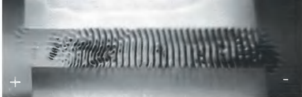
Рис. 3. Под действием сильных токов на поверхности металлической пленки возникает чередование горячих и холодных участков.
