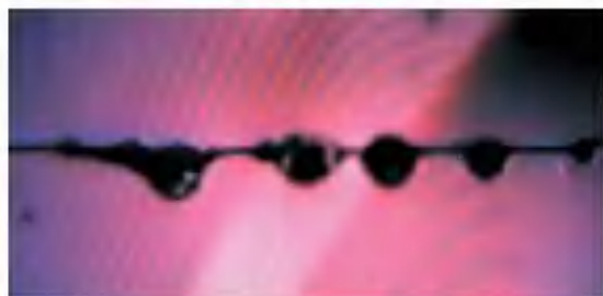
Рис. 1. При плавном повышении силы тока цинковое покрытие на проводнике вздувалось и на нем появлялись «бусинки».
