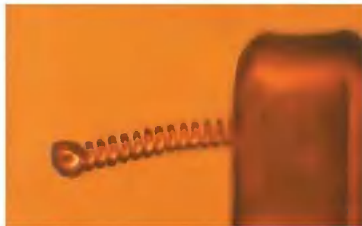
Рис. 4. Холодный вольфрамовый усик, по нему даже ток не течет, а капелька почему-то образовалась...
